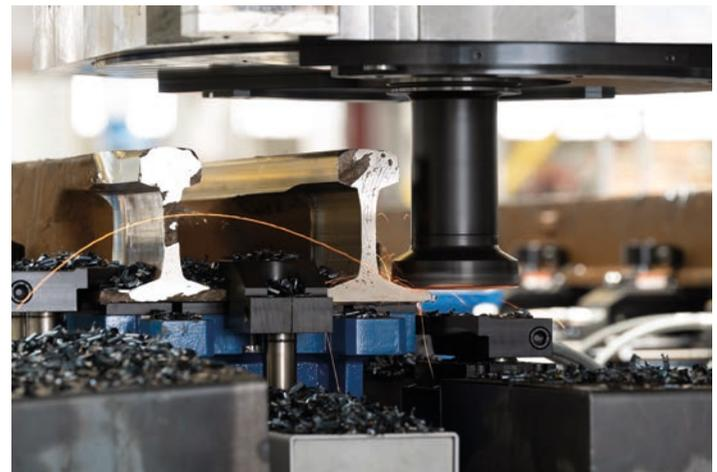
per lavorare quel tipo di materiale e ottenere produttività, si devono utilizzare frese di grande diametro e con numerosi inserti; ciò determina grossi sforzi sulla macchina. Per questo motivo particolare atten-
