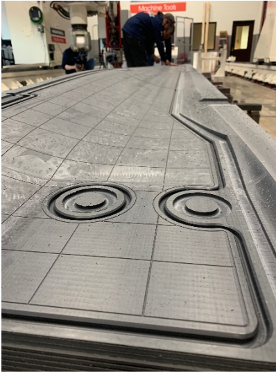
Superficie del pezzo dopo la lavorazione, prima della sigillatura
